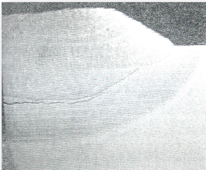
نمونه‌ای از ترک زیر بستر بوجود آمده در منطقه جوش یک فولاد کم آلیاژ استحکام بالا
