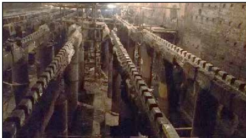
شکل ۵. رایدیهای نصب شده بر روی بیم کوره ی پیش گرم شماره ۲
