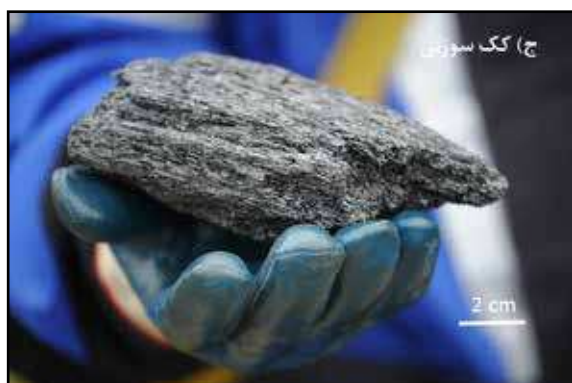
شکل ۹. ساختار ماکروسکوپی کک، الف) دانه‌ای، ب) اسفنجی و ج) سوزنی.
