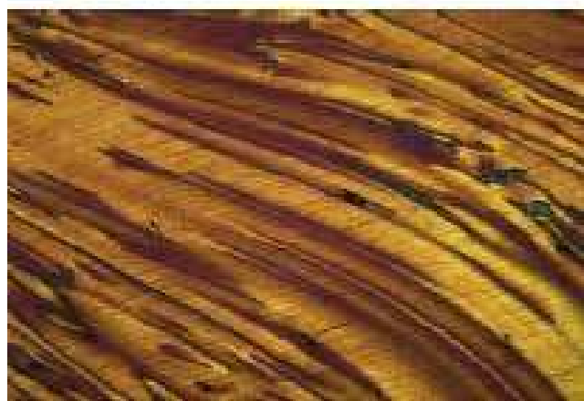
شکل ۵. میکروگراف نوری پلارایز شده کک خام تهیه شده از روغن آنتراسن [۷].
