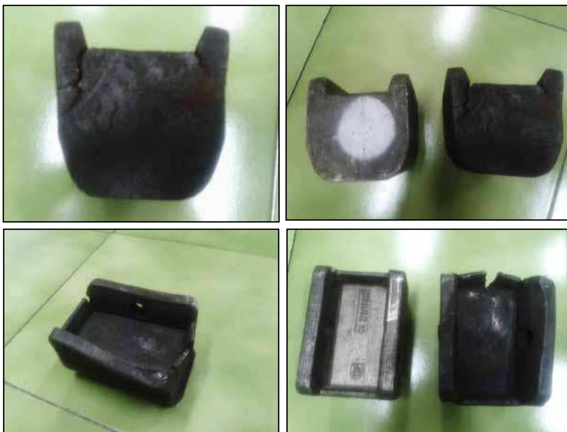
شکل ۲. تصاویری از رایدِر مستهلک که دچار شکست شده در مقایسه با رایدِر نصب نشده
