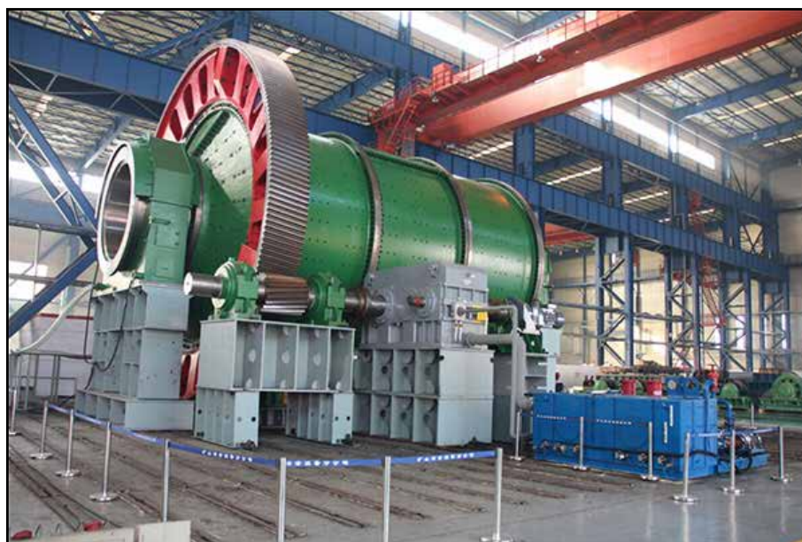
شکل ۱. نمونه‌ای از آسیای افقی گلوله‌ای غلتان.
