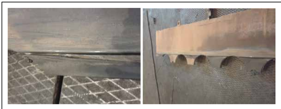
شکل ۲. خراش ایجاد شده در سرتاسر صفحه‌سایشی در اثر برخورد ورق نورد شده. خراش صفحه‌سایشی در بزرگنمایی بالاتر. براده‌های ایجاد شده در اثر صفحه‌سایشی.
