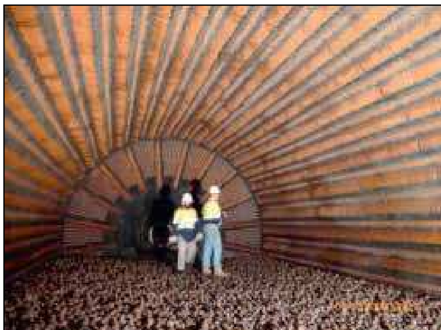
شکل ۲. نمای داخلی یک آسیای افقی گلوله‌ای غلتان بزرگ.
