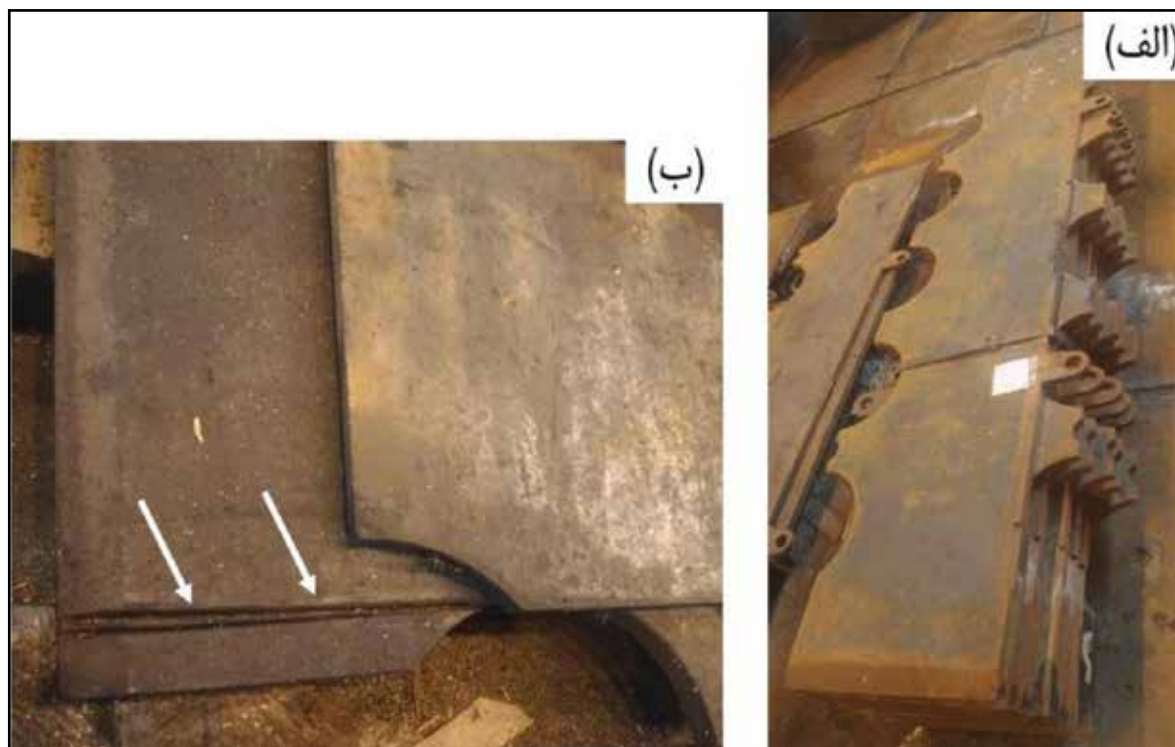
شکل ۱. (الف) تصویر صفحه سایشی مورد استفاده و (ب) تخریب شدید صفحه سایشی از جنس فولاد St52.
