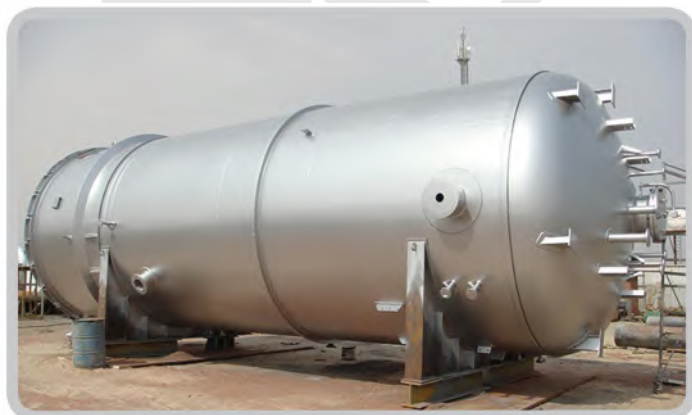
شکل ۲-۱۳. یک نمونه مخزن تحت فشار استوانه ای مورد استفاده در صنایع نفت و گاز.
