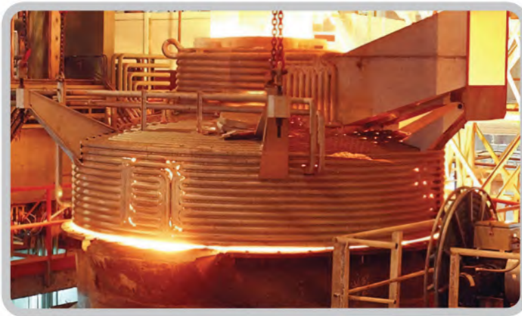
شکل ۴-۲. شارژ قراضه در کوره قوس الکتریک.
